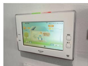
太陽光による発電量と電力消費量がひと目で分かるモニター。エネルギーを見える化して省エネにつなげる。
